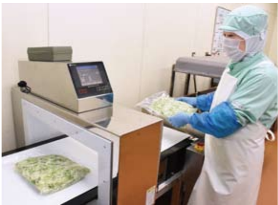
パックに詰めたカット野菜はすべて金属探知機でチェックして出荷
